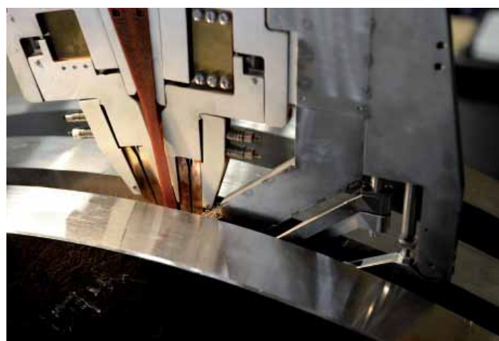
Двухстороннее слежение по стыку
